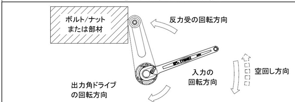
出力角ドライブを左方向(反時計回り)に回す場合
