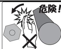
⑤入力作業完了後、レンチをボルト／ナットから取り外すことが困難な場合があります。これは、レンチ内部から発生した弾性力による荷重が、反力受とボルト／ナットの間にかかっていることによるものです。
