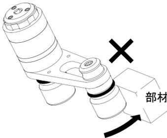
※角軸に取り付けたソケット外周部と、隣接のボルトナットや部材で反力を受けないでください。
