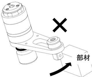
※角軸と、隣接のボルトナットや部材で反力を受けないでください。
