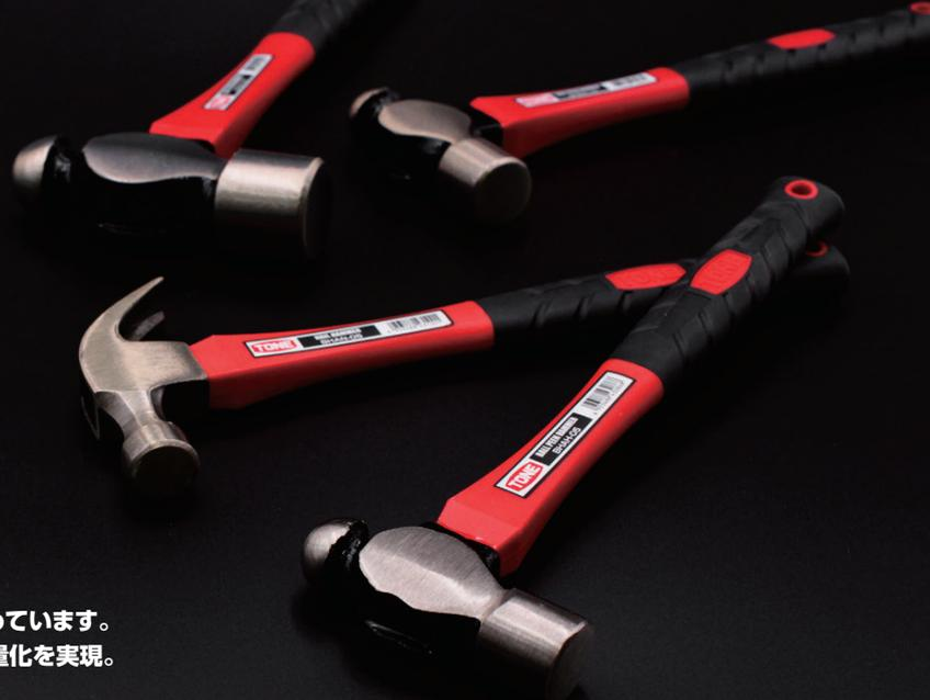
片手ハンマーはピン等の打ち込み、組立、着脱調整、R状の曲げ、リベット先端カシメ加工などの打撃に使用します。
