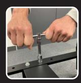
角ドライブがハンドル上をスライドし、任意の位置に 合わせて使用できます。力を加えた時に角ドライブが 回らないように、ハンドルに溝が加工されています。 また、角ドライブが中心にくるとストッパーが働きます。
