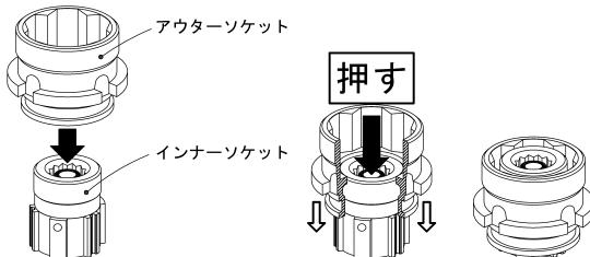
○インナーソケットスプリングがコードレスレンチに正常にセットされているか、確認してください。次に、アウターソケットとインナーソケットをセットした状態で、アウターソケットの凹凸部を本体のアウターソケットホルダの凹凸部の位置に合わせて差し込みます。
