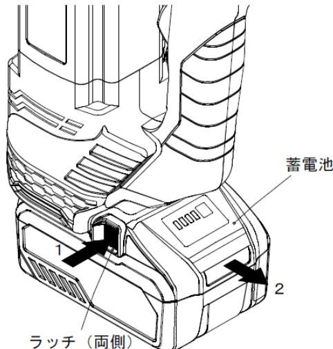
○蓄電池をレンチ本体に取り付けるときは逆の要領で、レンチ本体の溝に合わせ、奥まで挿入してください。この際に、「カチッ」と音がするまで、奥まで確実に挿入してください。
