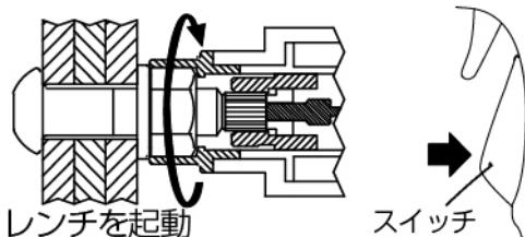
○締付けが進むと回転スピードが徐々に遅くなり、規定トルクに達すると、ボルトの破断溝部で
