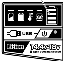
電池容量ランプ
